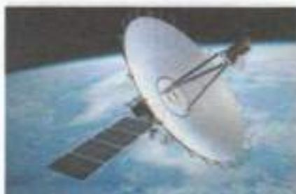
в апогее он удалится от Земли на расстояние 350 тыс. км, его угловое разрешение может достигать всего лишь миллионных долей угловой секунды, что в 30 раз лучше, чем у наземных систем. Он позволяет получить самое высокое
