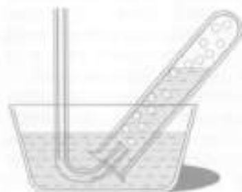
Рис. 4.1. Некоторые газы можно собирать в сосуд методом вытеснения воды
