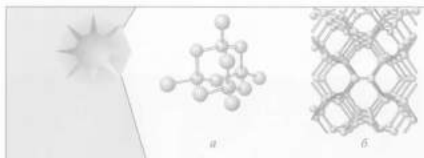
Рис. 3. Атомная кристаллическая решетка алмаза: a — фрагмент из элементарных тетраэдров; b — бесконечный кристалл
