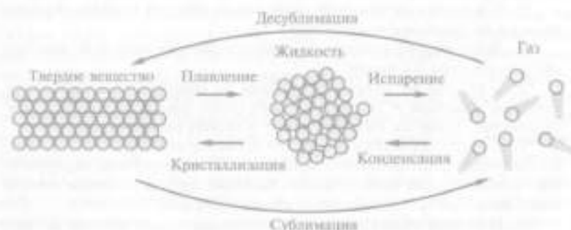
Рис. 3.2. Схема взаимных переходов агрегатных состояний вещества
