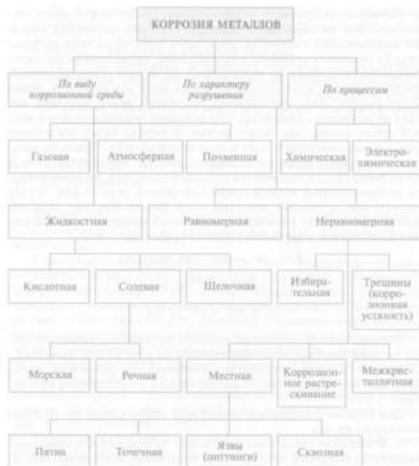
Рис. 7.1. Классификация видов коррозии металлов
