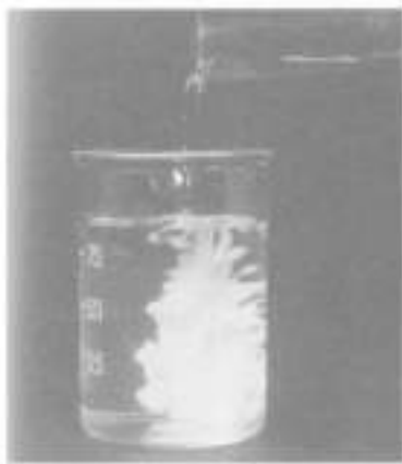
Рис. 17. Образование осадка гидроксида свинца(II) по реакции обмена
