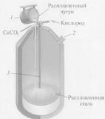
Рис. 22. Кислородный конвертер для вылавки стали: 1 — загрузочный ковш; 2 — выпускное отверстие; 3 — одноуровневая трубка
