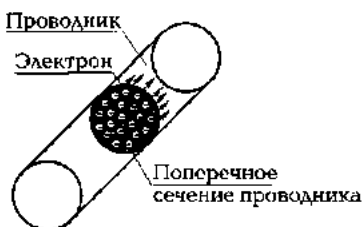
Рис. 1.3. Электроны, проходящие через поперечное сечение проводника
