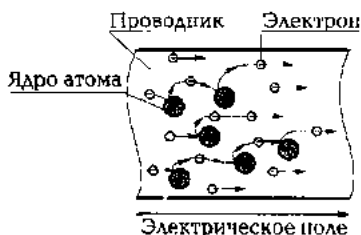
Рис. 1.4. Схема, поясняющая понятие сопротивления
